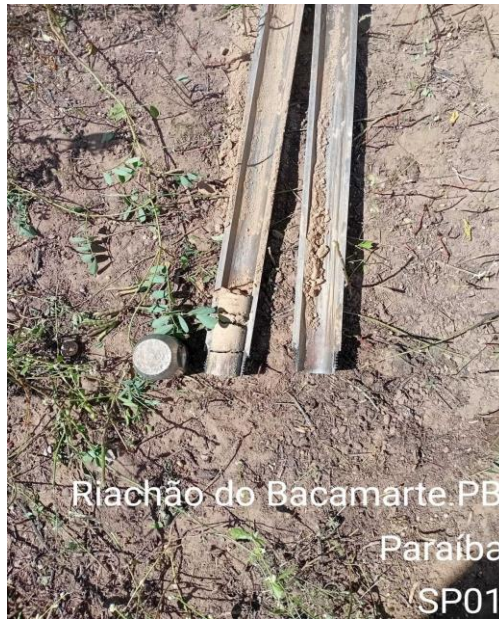
FIGURA 1: EXECUÇÃO DE SONDAGEM EM RIACHÃO DO BACAMARTE/PB
